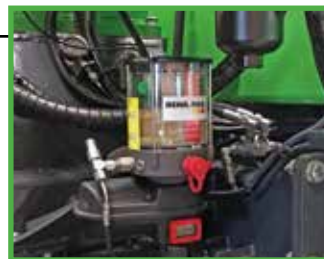
Automatische Zentralschmierung Einfache und schnelle Schmierung
