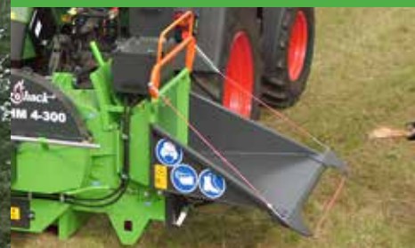
Einzugsabschaltung durch Stahlsicherungsseil
